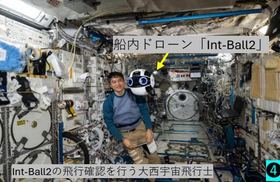
船内ドローン「Int-Ball2」 Int-Ball2の飛行確認を行う大西宇宙飛行士 ④
