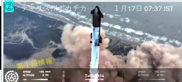
第1段の33基のラプターエンジンは予定通り作動しましたが上昇にスターシップの上段が故障しました。第1段は計画通りに無事回収に成功しました。
