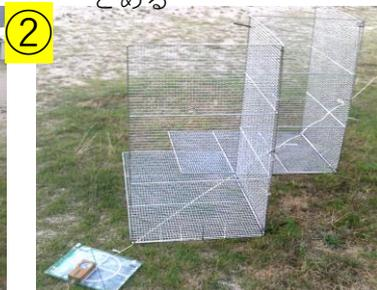
縦長に組立てた金網CR底面の対角線と補助線を重ねる
