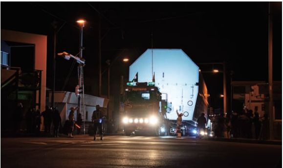
夜間の H3 ロケット陸送運搬。大型コンテナを通過させるために信号機を 90 度回転させている。（写真提供：南種子町）
