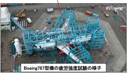
☆疲労強度試験(Fatigue Load Test)☆
