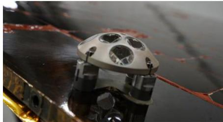
NASA依頼の6つのNova-C搭載の1つがレーザー再帰反射鏡
