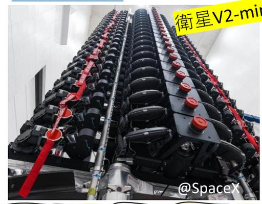
G6-1では大きくなった新しいタイプ「V2-mini」の21機の衛星を搭載。より強力なフェーズドアレイアンテナ等も積まれ旧版の最大4倍の容量データが提供できます。
