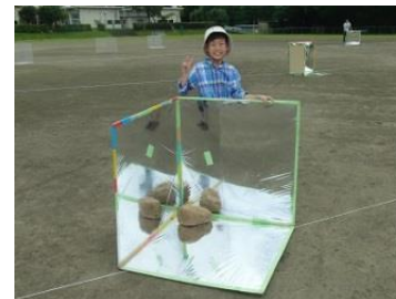
手作りの電波反射鏡
