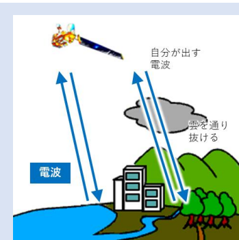
合成開口レーダのしくみ
