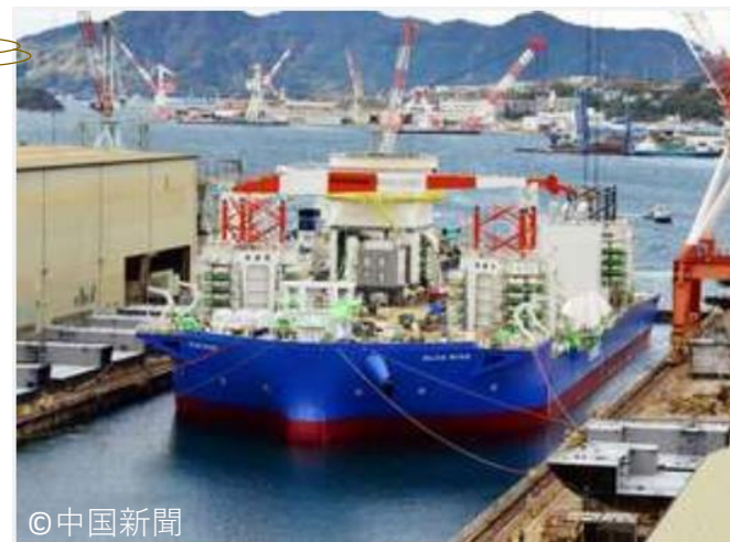
J M U 呉事業所で建造が進む世界最大級のSEP船
