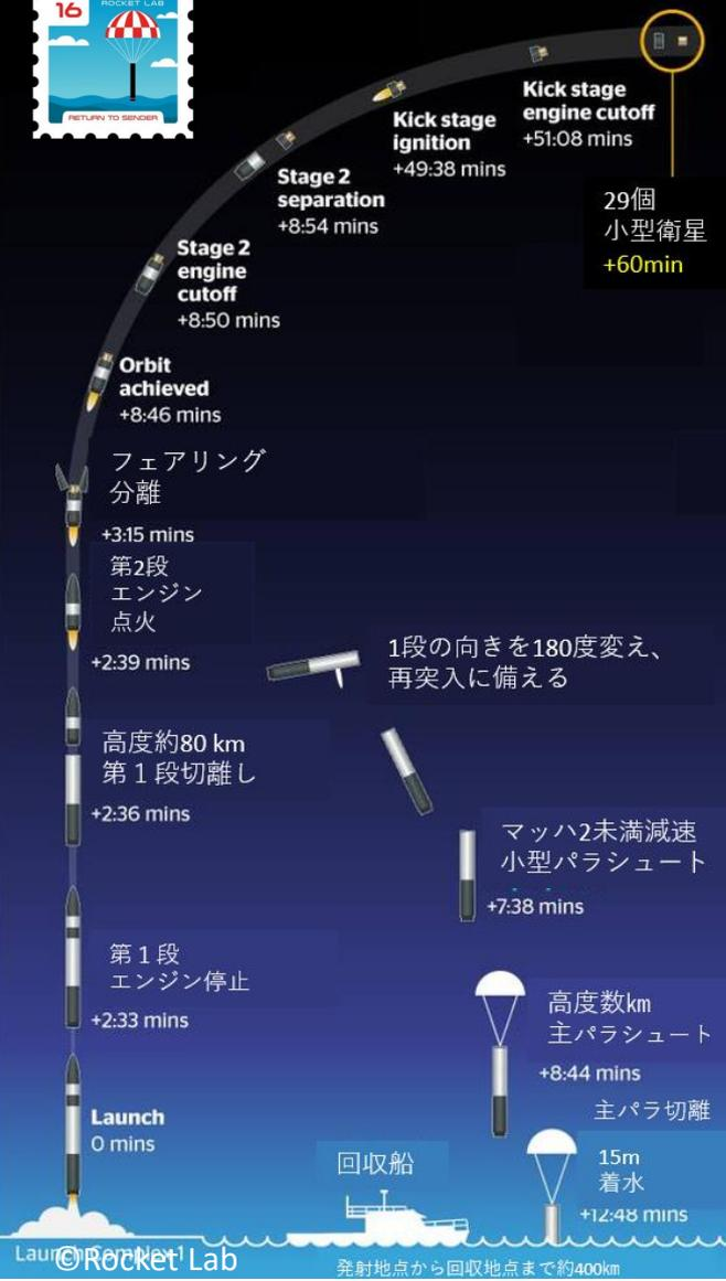
打上げ費用を節約するためにブースターの再利用は極めて需要です。小型衛星の打上げ市場で特色を持つロケットラボは持っています。更に打上費用を下げるためにブースターの再利用の研究を進めています。ファルコン9はブースターを着地のために利用していますが、スピードを落とすのに耐熱シートを工夫する等して再突入を成功させパラシュートを利用して着水しました。再利用のためには回収後の処理が工夫されていたのでしょうか。
