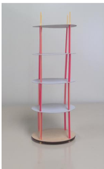
図13. (左) 基本構造に (右) パスタを追加して曲がりにくくした構造
