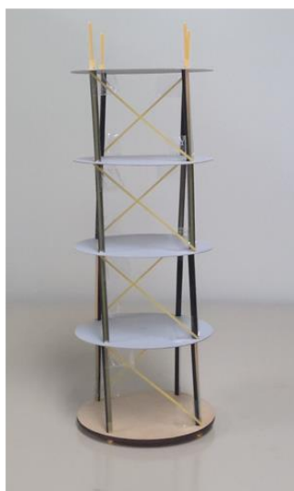
図13. (左) 基本構造に (右) パスタを追加して曲がりにくくした構造
