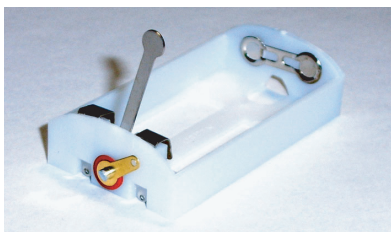
電極がむき出しの電池ボックス
