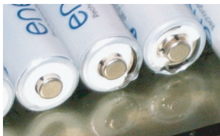
▲熱で溶けた電池の電極付近
