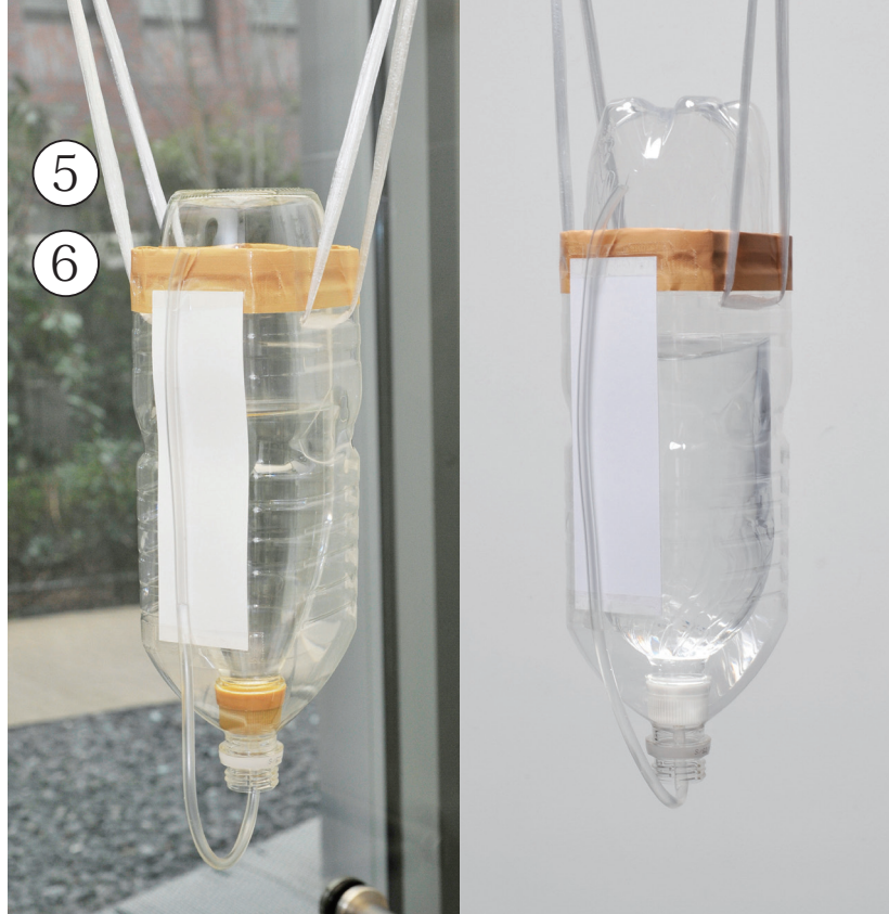
▲完成した水気圧計（左）。右はガラスびんの代わりにペットボトルを、ガラスびんホルダーに入れた水気圧計。
