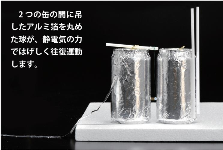
2つの缶の間に吊したアルミ箔を丸めた球が、静電気のためにはげしく往復運動します。
