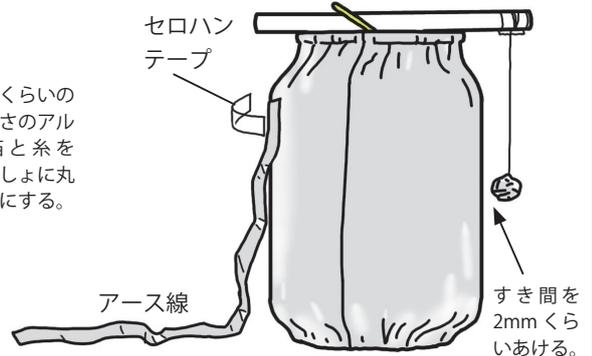
発泡スチロールの板の上に缶をのせて、2つの缶が振り子から2mmくらい離れるように置き、アース線についていないほうに、こすって静電気の起きたストローをつけます。
