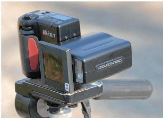
★ピントの合わせ方：可視光で撮影するとき遠景は距離「無限∞」でピントが合いますが、赤外線透過フィルターをつけたときは、(右写真の) COOLPIX950 の場合 1.5m あたりでピントが合います。カメラによってどのあたりでピントが合うか、テスト撮影して確かめましょう。
