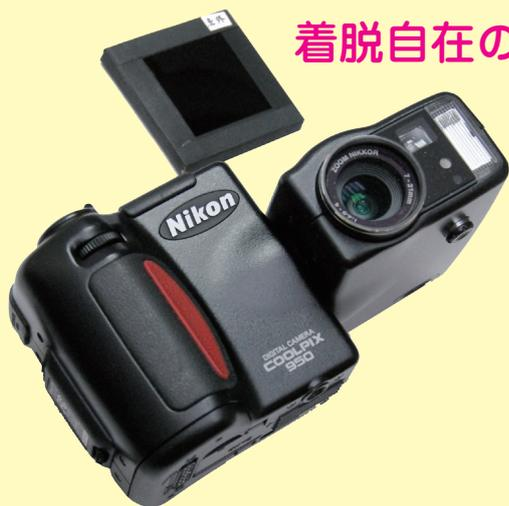
ゼラチンフィルターをカメラのレンズに合わせた大きさに切って、両面テープで貼るだけでも使えます。しかし、せっかくだから後々まで使えるように、また、可視光・赤外線のどちらも好きなきときに撮影できるように、着脱自在のフィルターを自作しましょう。
