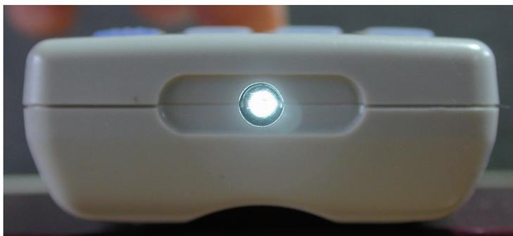
▲デジタルカメラで撮影したリモコンの赤外線。明るく写るデジタルカメラほど赤外線をよく感じる。
