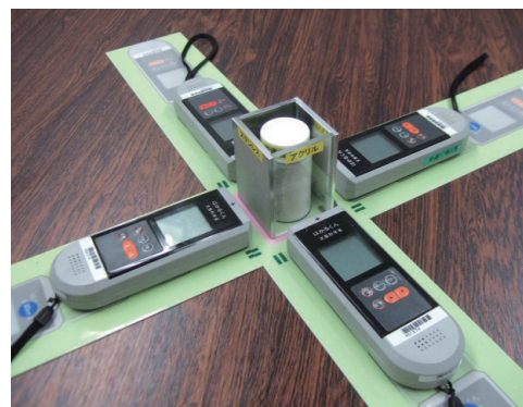
▲はかるくん「特性実験セット」は、距離と放射線量の関係やものによって異なる遮へいの効果の実験ができる。
