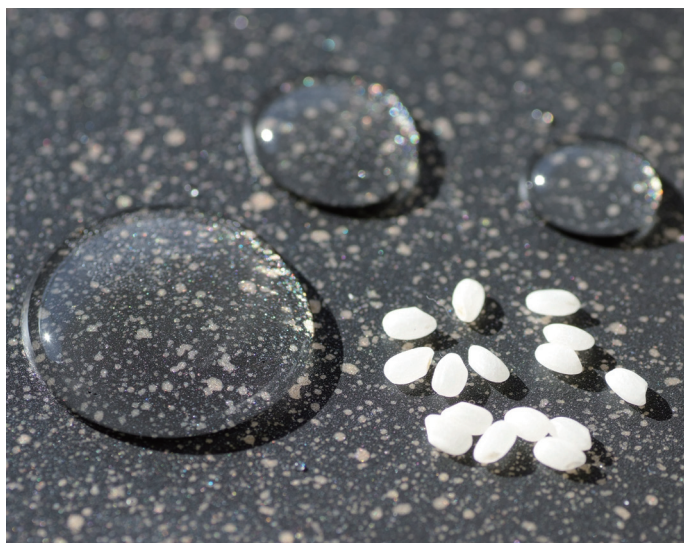
▲テフロン面上にできた水玉（比較のために米粒を置いた）。
