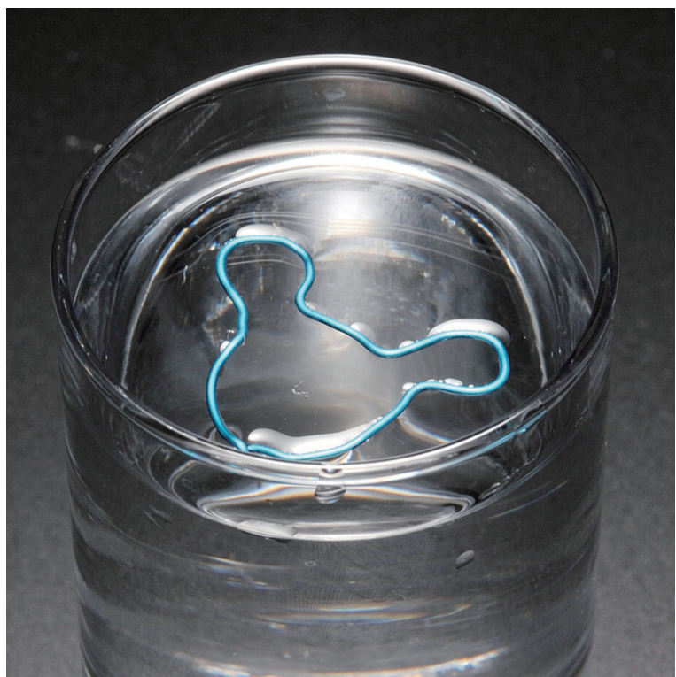
● アルミニウムの針金の水に浮かぶわけ 水の表面にはたらく表面張力(分子どうしが引き合う力)が、アルミニウムの針金の重さを支えているからです。
