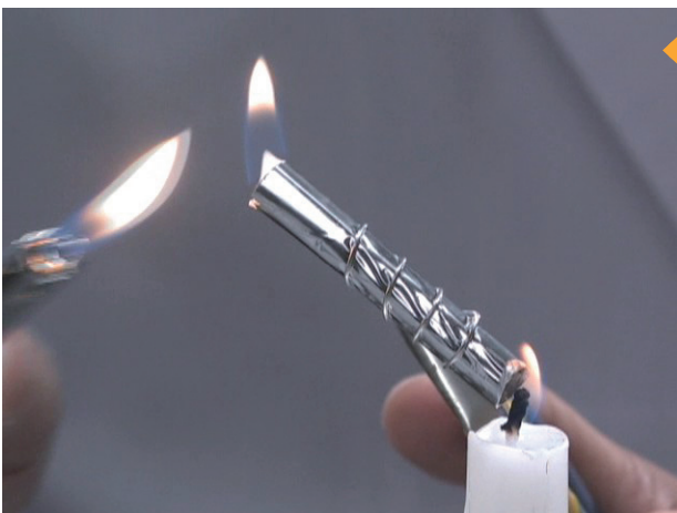
◀ろうの蒸気に点火用ライターで火をつける。芯がなくても、気体になったろうが燃えることがわかる。
