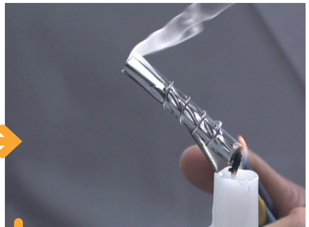
▲ろうそくの炎の下の暗い部分にパイプを入れると、反対側からろうの蒸気が出てくる。
