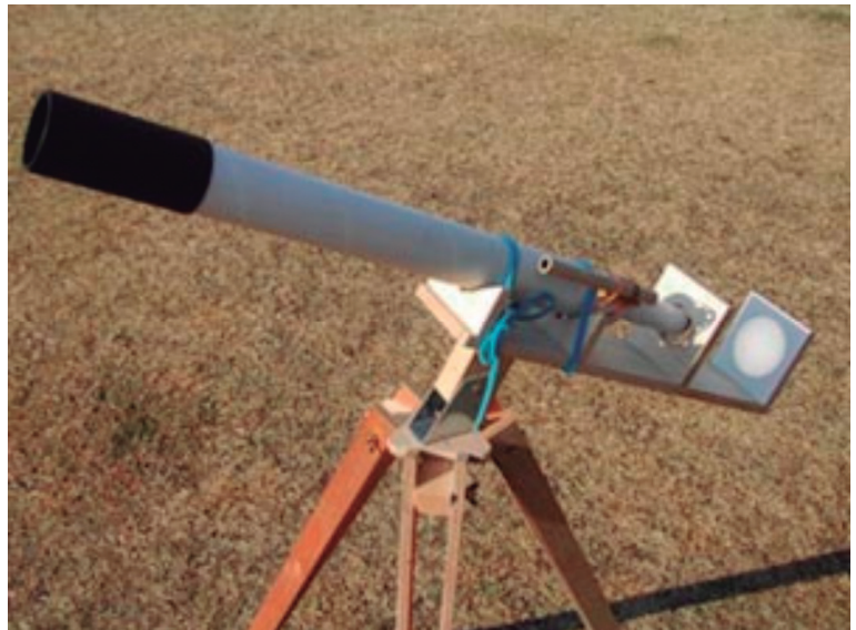
「投影法」太陽を観測するときは、この写真のように紙に投影する。
