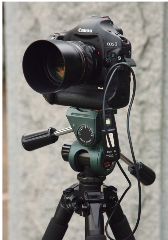
しっかりした三脚にセットされたデジタル一眼レフカメラ。（手でボタンを押すときの振動を避けるための電子リリースも、あるとよい。）
