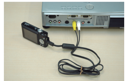
デジタルカメラとプロジェクターの接続例。（AVコードなどでつなく。）
