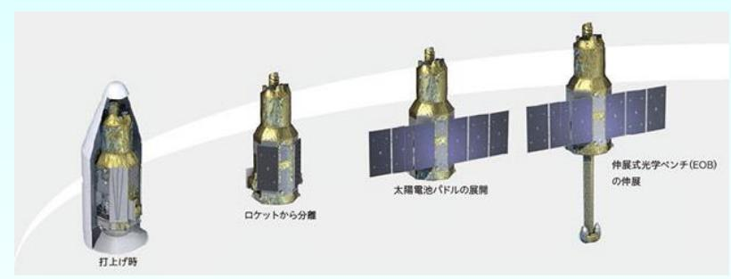
打ち上げ後、太陽電池パドルを展開して、伸展式光学ベンチ (EOB) を伸ばすことで、硬X線撮像に必要な焦点距離12mを確保する。新しい仕組みと、国産ナノ技術を駆使して開発することで、「ひとみ」は硬X線帯域において、先代の「すざく」より100倍高感度の観測を実現して、これまでに知られていない熱い宇宙の姿を捉えるが可能になった。
