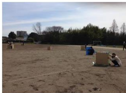
製作の様子 (90cm×90cmの段ボール紙にアルミシートを貼ったものです)
