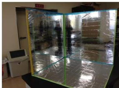
製作の様子 (90cm×90cmの段ボール紙にアルミシートを貼ったものです)
